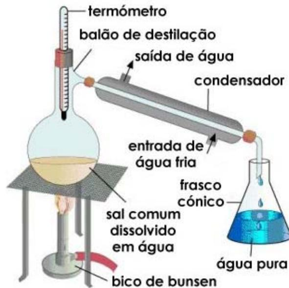
Material de laboratório utilizado em destilação (Sec. XX)
