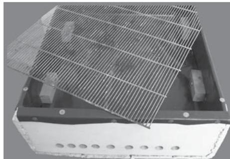
A tela de viveiro de passarinho foi fixada com auxílio de pedaços de madeira que foram parafusados na caixa. Note que a tela foi presa ao pedaço de madeira para ter maior firmeza.
