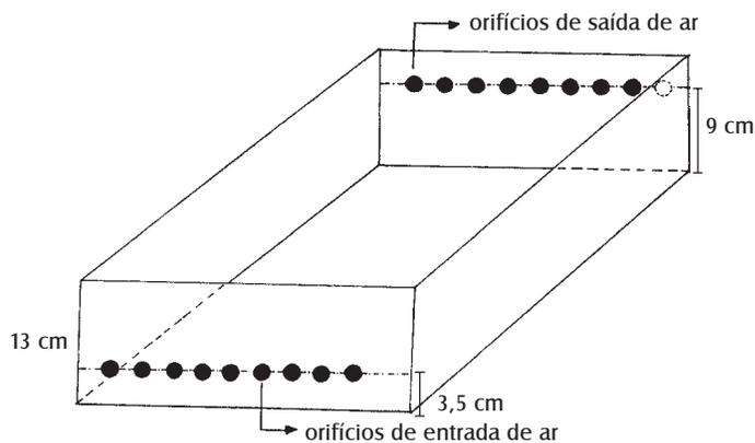
Pode-se fazer por volta de 9 orifícios de cada lado. Esses orifícios servem para entrada e saída de ar. O ar entra pelos orifícios na parte inferior da caixa, retira água do alimento que está em processo de secagem e sai pelos orifícios na parte superior da caixa.
