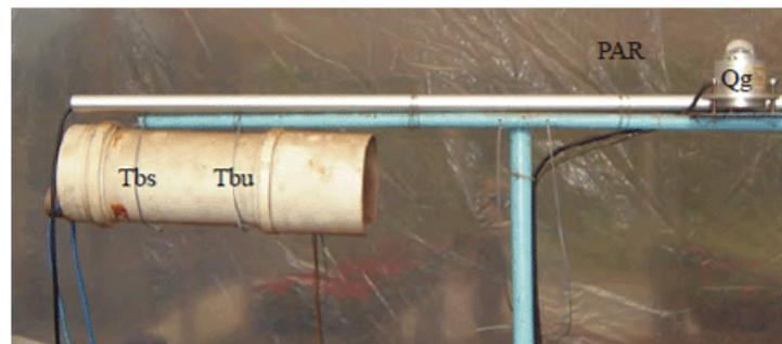
Figura 2. Instrumentos meteorológicos instalados em cada tratamento: radiação solar global ( $Q_g$ ), radiação fotossinteticamente ativa (PAR), temperatura de bulbo seco ( $T_{bs}$ ) e temperatura de bulbo úmido ( $T_{bu}$ ) (psicrômetro ventilado)
