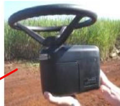
Atuador de um Piloto Automático Elétrico na Coluna de Direção
