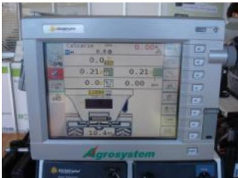
... controlando as seções da barra de um pulverizador
