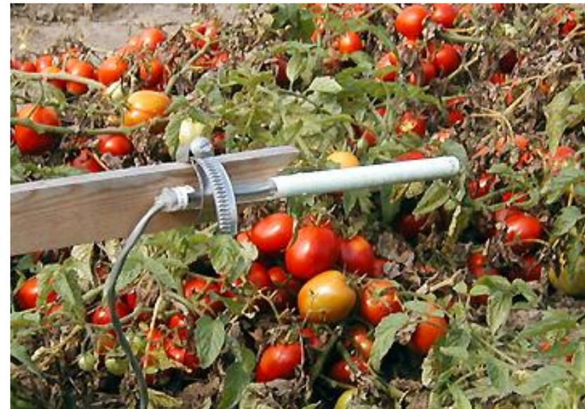
**Folha artificial – sensor cilíndrico**
