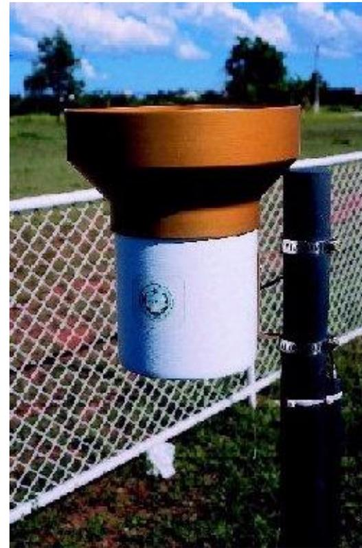
Os pluviômetros de balança são sensores eletrônicos para a medida da chuva, usados nas estações meteorológicas automáticas. Eles possuem duas básculas, dispostas em sistema de gangorra, com capacidade para armazenar de 0,1 a 0,2mm de chuva. Conforme a chuva vai ocorrendo o sistema é acionado e um contador disposto no sistema de aquisição de dados registra a altura pluviométrica acumulada. Esse equipamento registra o total de chuva, o horário de ocorrência e a intensidade.
