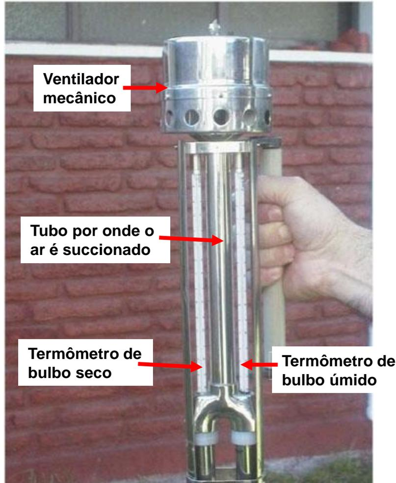
O psicrômetro Assmann é considerado padrão para a medida da umidade do ar. No entanto, este é um equipamento mecânico. Outras versões desse tipo de sensor vem sendo desenvolvidas, mas todas usando o princípio das medidas das temperaturas do bulbo seco e do bulbo úmido.
