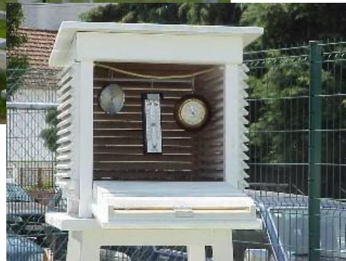
Abrigos meteorológicos utilizados em estações meteorológicas convencionais
