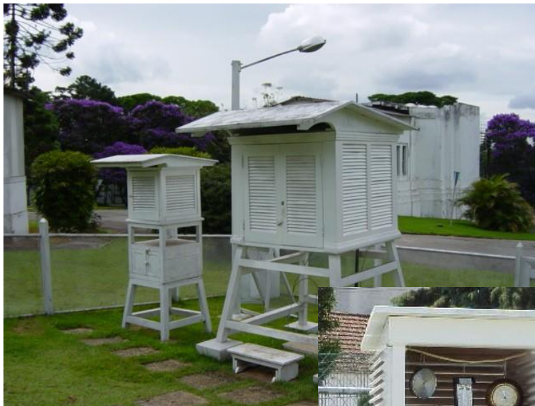
Abrigos meteorológicos utilizados em estações meteorológicas convencionais
