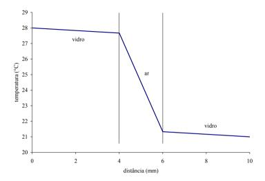
Observa-se que, nas partes de vidro, que têm uma maior condutividade térmica, o decréscimo da temperatura com a distância (o gradiente térmico) é muito menor que na camada de ar, que tem uma menor condutividade térmica. Dessa forma, o produto da condutividade e gradiente, que resulta na densidade de fluxo de energia (q) pela equação 5.1, é igual em toda parte do sistema.
