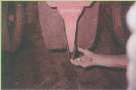
**Ajuste dos discos duplos deve ser feito, substituindo-se a graxa velha por nova**
