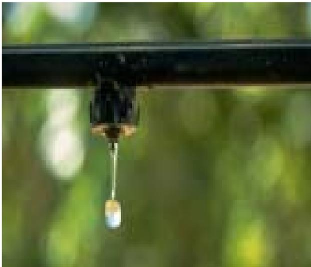
**Emissor "on-line"** é aquele que foi projetado para instalação na parede de uma lateral de irrigação, quer diretamente ou indiretamente por meio de microtubos.
